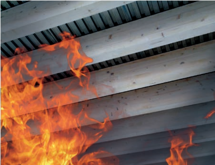
Feuerwiderstand einer Fußbodenkonstruktion mit LEWIS®-Schwalbenschwanzplatten
